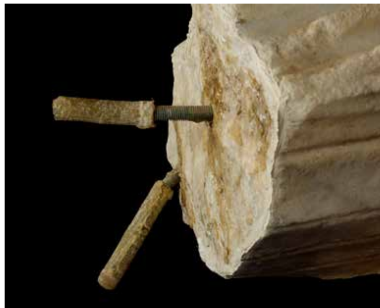
1. Particolare dei vecchi perni in acciaio sulla superficie di contatto del busto
