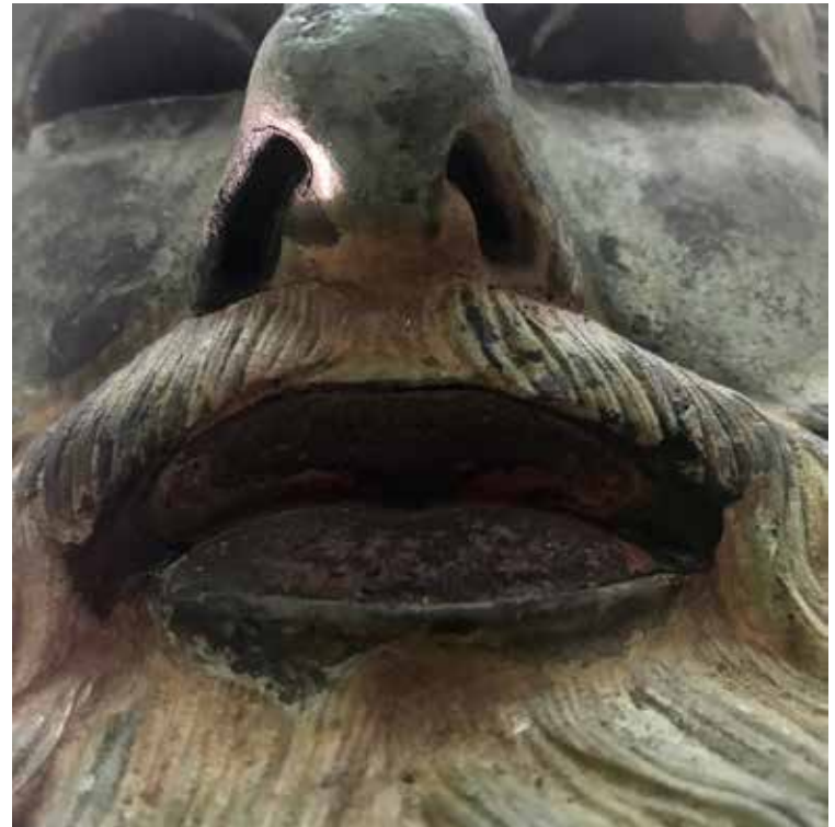
Prima del restauro, scorcio della parte inferiore del volto con patine di corrosione scure lungo il solco delle narici e spatatura del bronzo delle labbra
