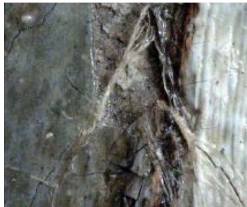
5. Prima del restauro, immagine al microscopio digitale in corrispondenza del basamento del manichino femminile; particolare della lacuna della pellicola pittorica con filo di tela che emerge da sotto il colore
