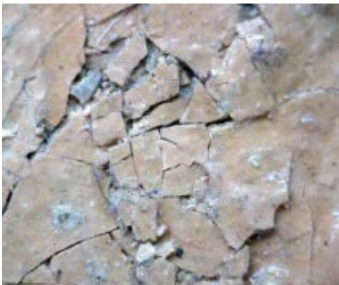
4. Prima del restauro, immagine al microscopio digitale in corrispondenza del basamento del manichino maschile; particolare del colore fratturato e sovrapposto
