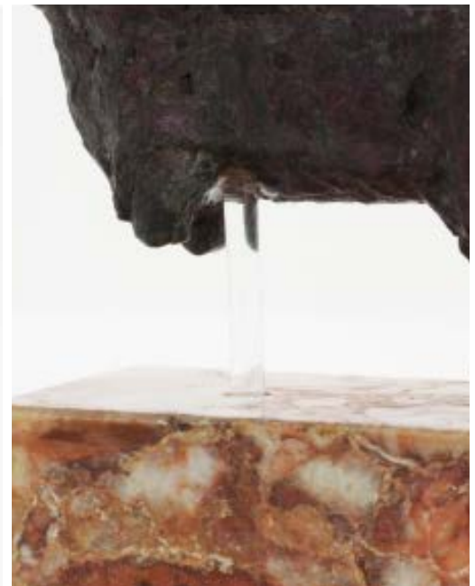
14. Prima e dopo il restauro, Osiride - Br 236. Visibile (a sinistra) la corrosione attiva della lega metallica per vaiolatura di sali clorurati
