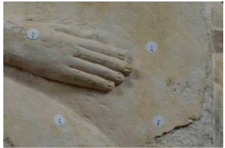
7. Prima del restauro, visione del lato destro con punti di applicazione delle sonde US nelle zone superficialmente degradate
