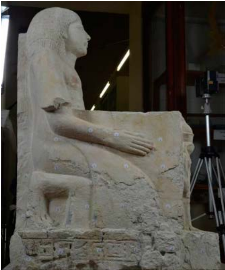
7. Prima del restauro, visione del lato destro con punti di applicazione delle sonde US nelle zone superficialmente degradate
